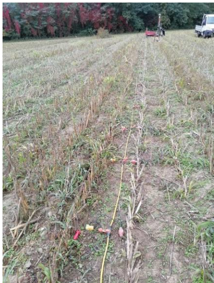
Stendimento sismico M.A.S.W.
